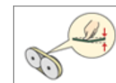
パワーステアリングベルトの 損傷・油量・油もれ・取付のゆるみ
